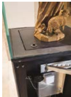
Enregistreur 160E avec sonde déportée spéciale vitrine
